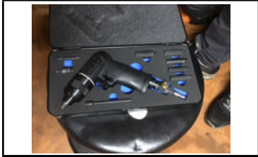
Clé à vibrations pour bougies de préchauffage CLAS
