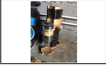
1 torrificateur de marque SAMIAC capacité 40 kg, fonctionnement au gaz
